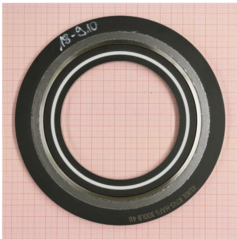
Compression test at RT (EN 13555)
