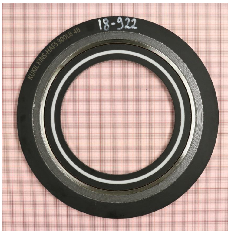
Creep relaxation test at 80 MPa - RT (EN 13555)
