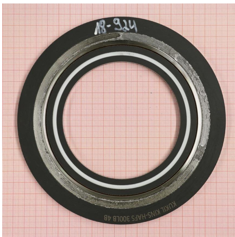
Creep relaxation test at 80 MPa - 150 °C (EN 13555)
