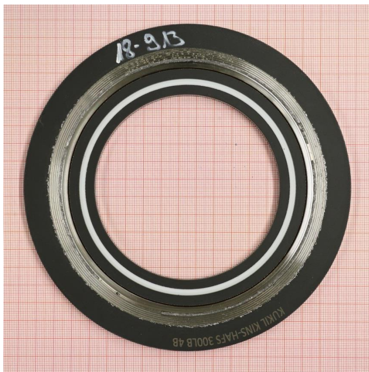
Compression test at 150 °C (EN 13555)
