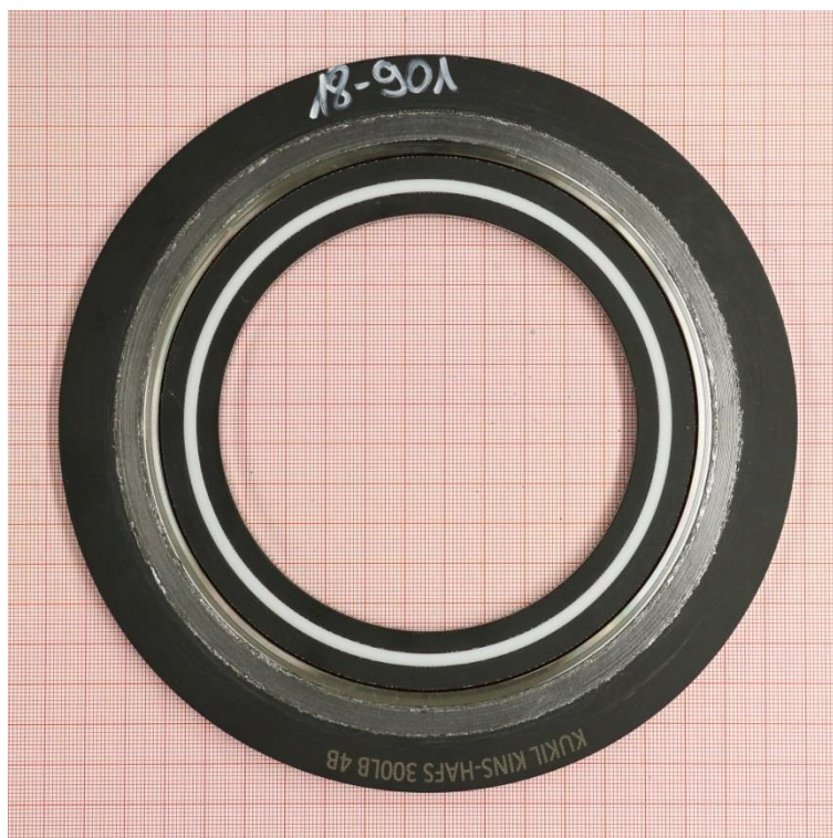
Leakage test at RT (EN 13555)
