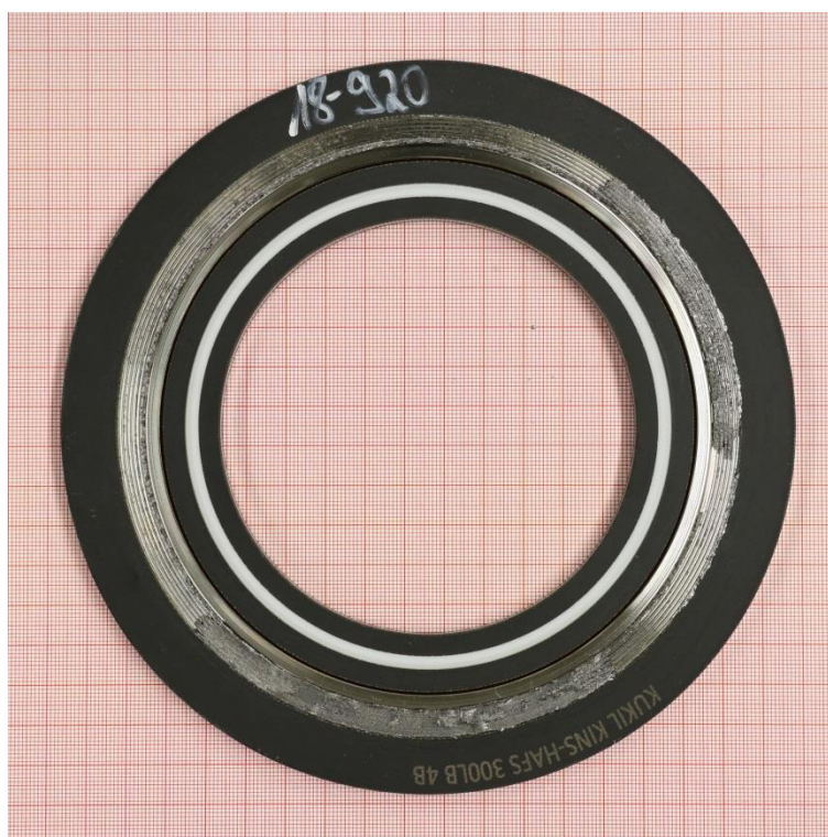
Creep relaxation test at 80 MPa - 150 °C (EN 13555)
