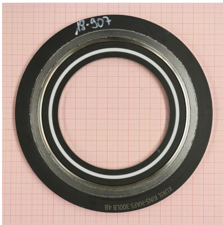
Leakage test at RT (EN 13555)
