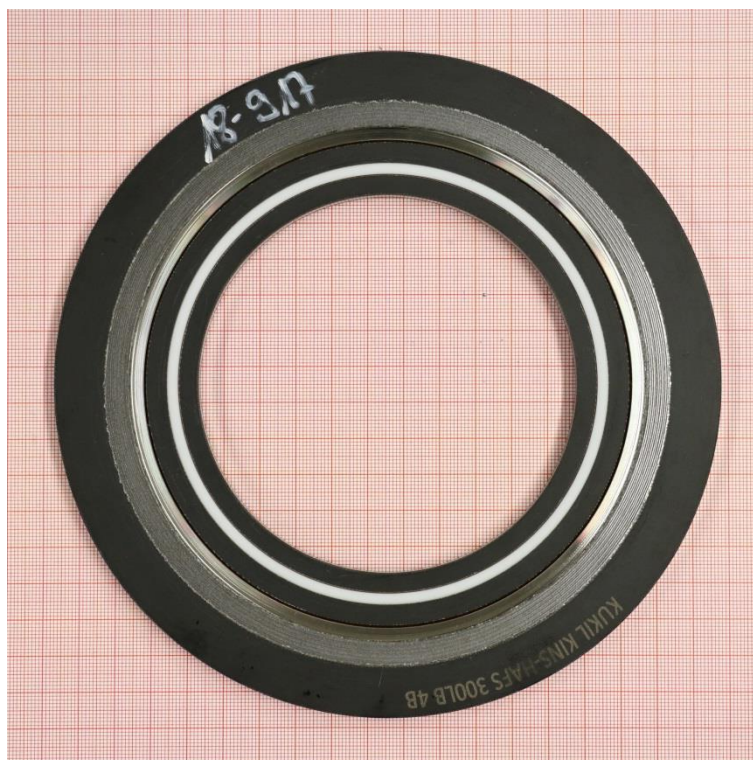
Creep relaxation test at 80 MPa - RT (EN 13555)
