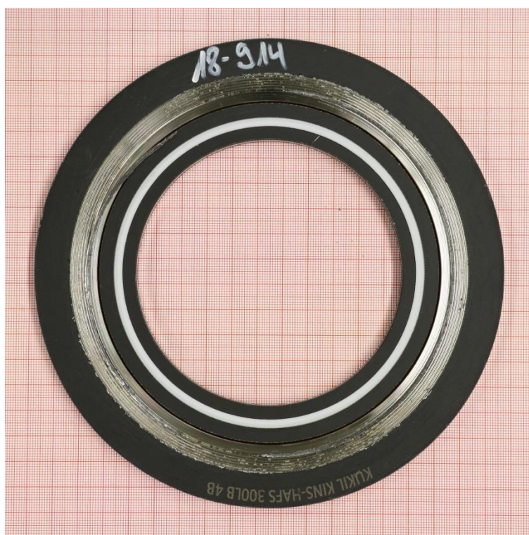
Compression test at 150 °C (EN 13555)
