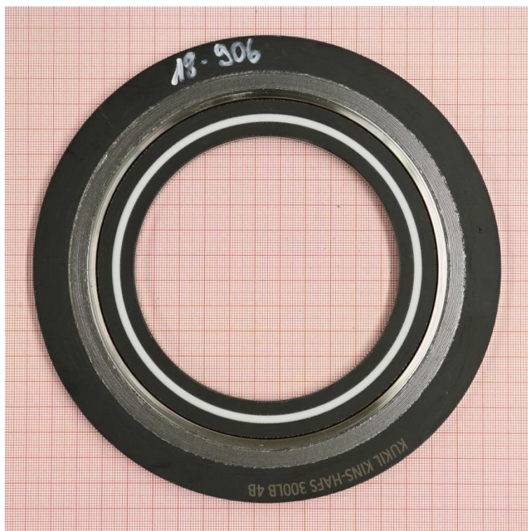
Compression test at RT (EN 13555)
